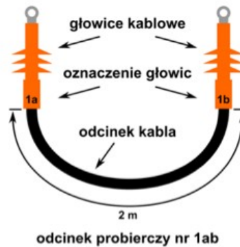
Rys. 3.11. Szkic budowy odcinka probierczego – „próbka kablowa – 1ab”.
