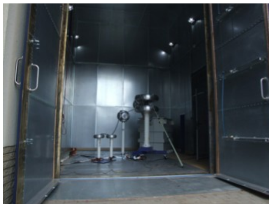
Rys. 3.10. Widok stanowiska do pomiaru WNZ – Instytut Energetyki Warszawa – Mory
