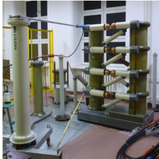
Rys. 3.9. Generatory udarów napięciowych; a) generator udarów piorunowych GU2400, b) generator stromych udarów napięciowych – GU400
