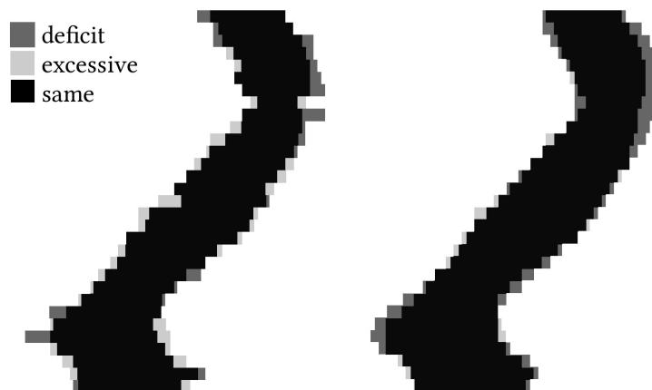
Rys. 1.12. Kryterium porównujące modele wokselowe konturów. Na rysunku przedstawiono przekrój przez obydwu kontury naraz.
